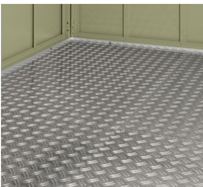
Aluminium traanplaatvloer Voor tuinbergingen type 1: 752 × 955 mm (3 stuks) Voor tuinbergingen type 2: 752 × 1128 mm (6 stuks) Voor tuinbergingen type 3: 726 × 1128 mm (8 stuks) Voor brandhoutrekken type 1: 554 × 720 mm (2 stuks) Voor brandhoutrekken type 2: 565 × 720 mm (3 stuks)
